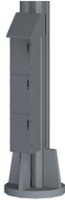
图 6.3.5 “杆箱一体式机箱”示意图
